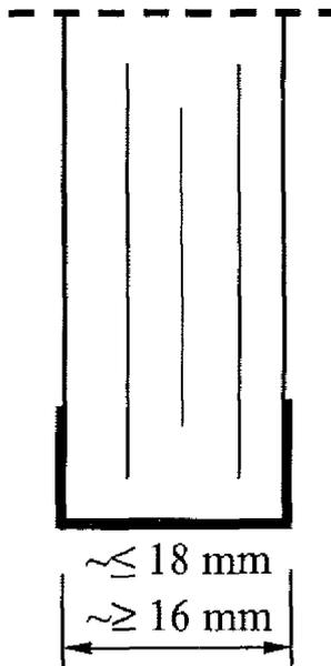
Brandschutz-Verbund-Sicherheitsglas gemäß DIN EN 14449 bestehend aus Floatglasscheiben mit zwischen liegenden Funktionsschichten.
