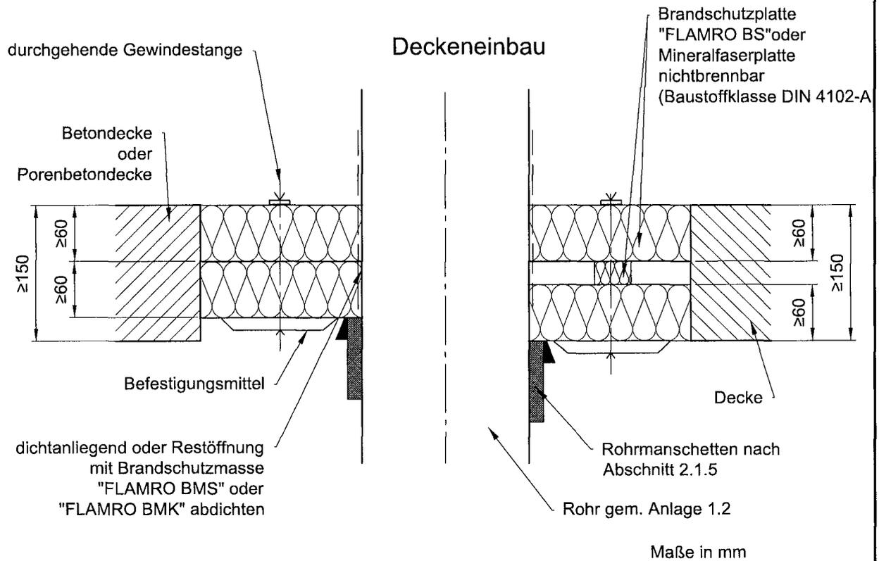
Kombiabschottung "FLAMRO-Multi-Kombischott" der Feuerwiderstandsklasse S90 nach DIN 4102-9
