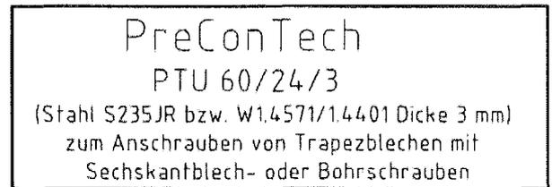
zur Kennzeichnung wird auf dem Rücken jeder Schiene ein Aufkleber angebracht.
