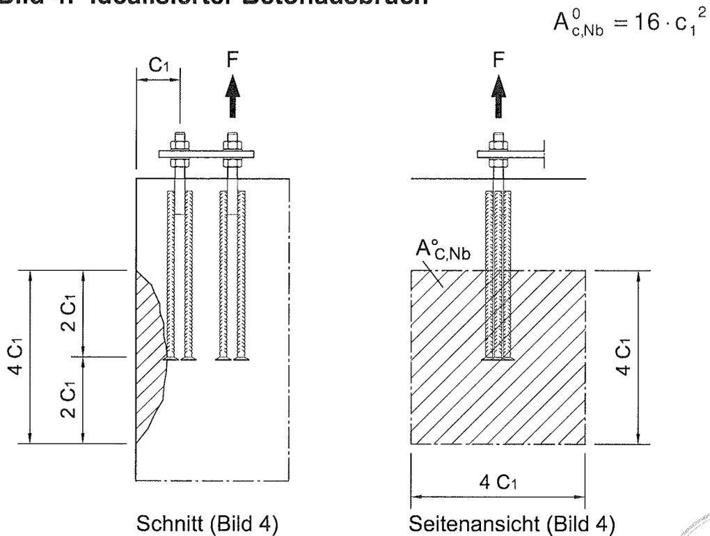
**Bild 5: Beispiel für lokalen Betonausbruch am Bauteilrand**
