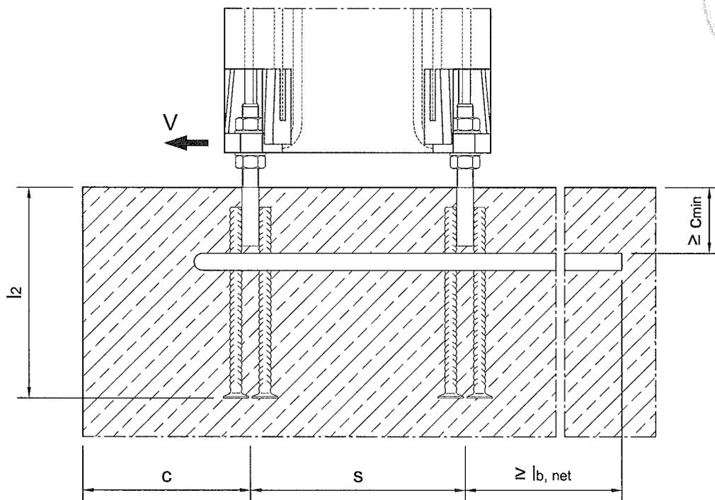
$c_{min}$ ,  $l_{b,net}$  und  $d_{br}$  nach DIN 1045-1
