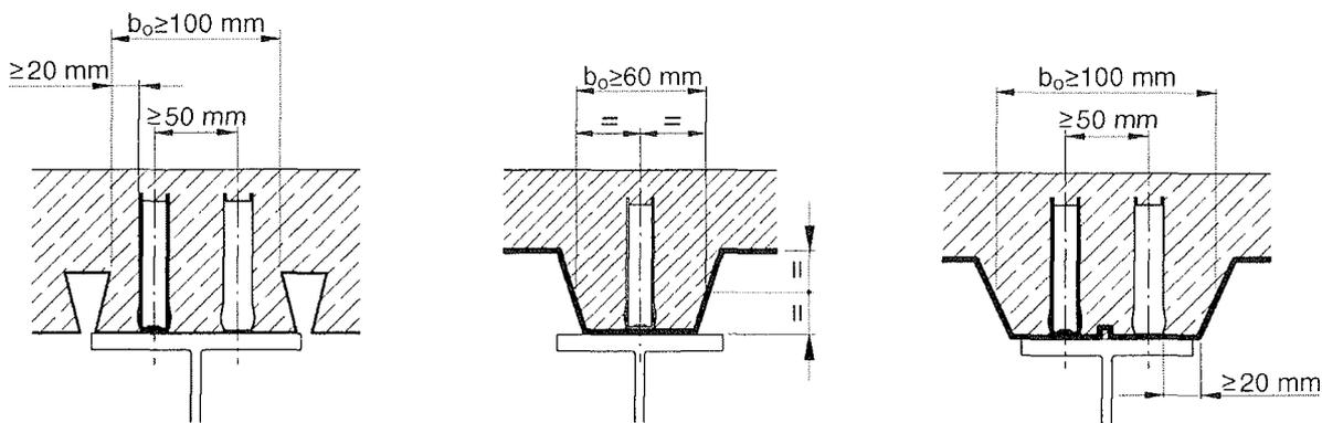
Ist eine zum Träger zentrierte Lage der Betonrippe auf Grund der Form des Profilblechs nicht möglich, ist das Profilblech in Längsrichtung zu teilen, Beispiel:
