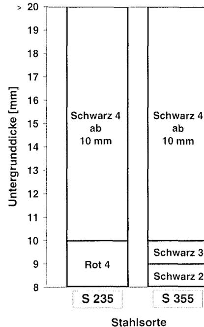
Anwendungsgrenzen gelten für Untergründe aus Baustahl gemäß DIN EN 10025-2 und Profilbleche gemäß DIN EN 10327 und DIN EN 10326.
