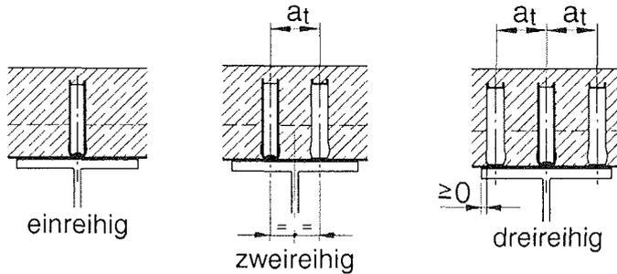
$a_t \geq 50 \text{ mm}$  für kompakte Profilbleche mit  $b_0/h_p \geq 1,8$
