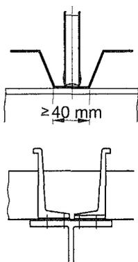
Schema a): Anschlag an Versteifungssicke
