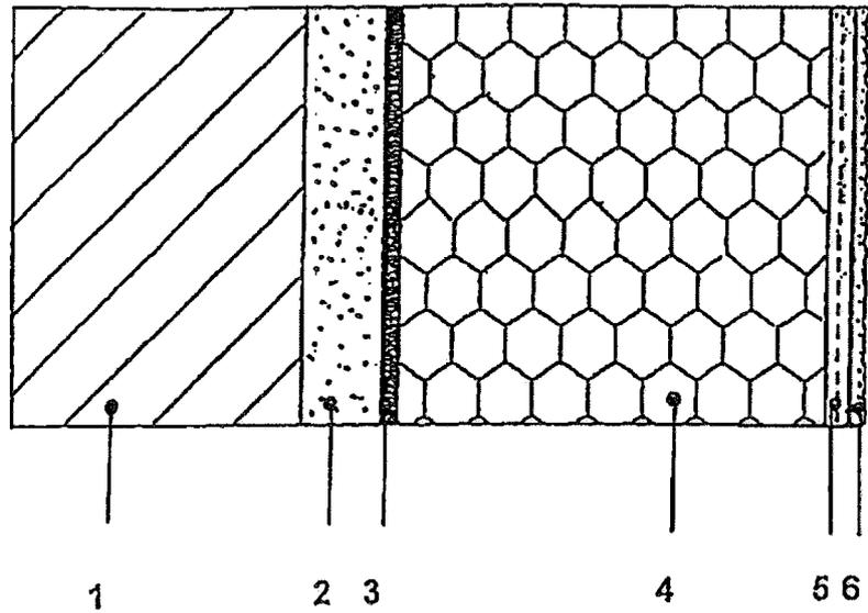
Teilflächige Verklebung der Mineralwolle-Lamellendämmplatten
