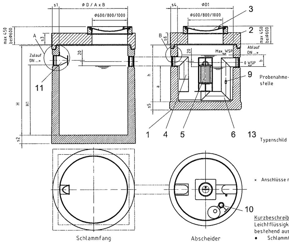
Variante Einlauf Schlammfang mit Zulaufsperrre DN 100, 150 u. 200
