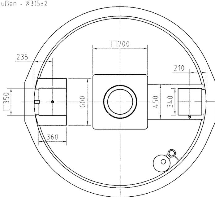
Probenahmeschacht als Probenahmeverrichtung gemäß DIN 1999-100
