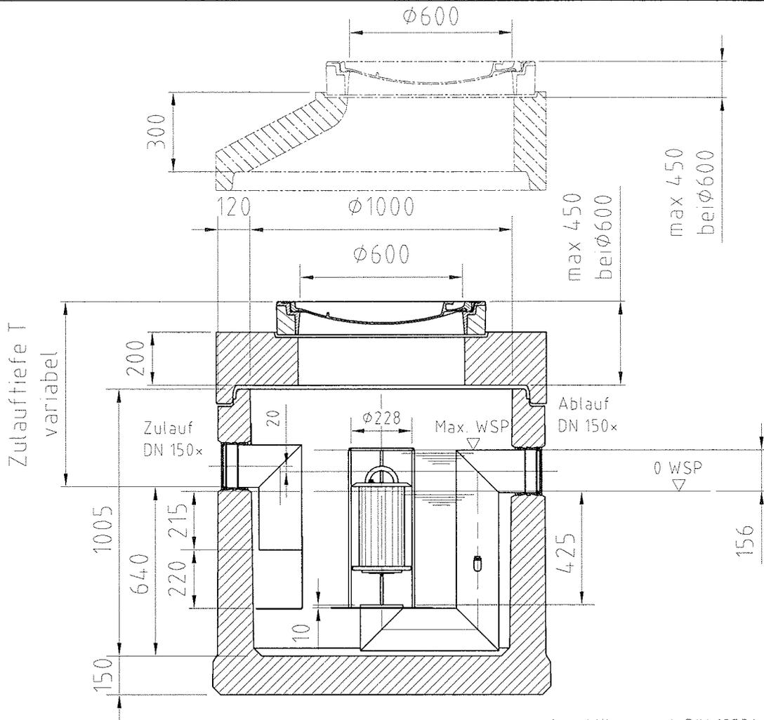
x Anschlüsse nach DIN 19534/19537 bzw. DIN EN 877
