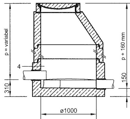
Ausführung mit integriertem Probenahmekasten
