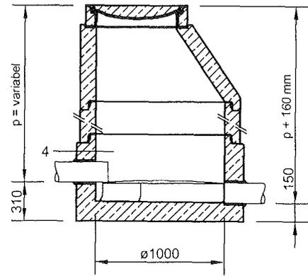
Ausführung mit integriertem Probennahemkasten
