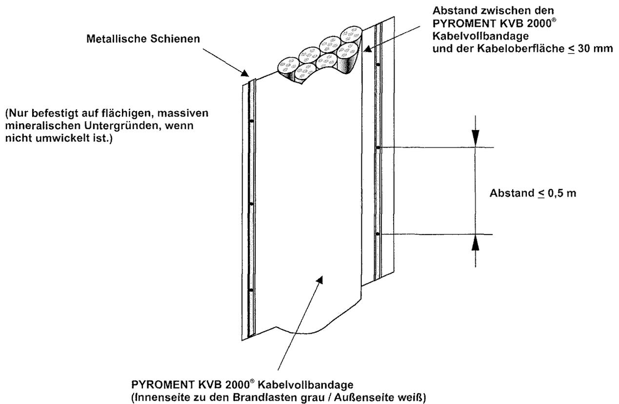
Abstand zwischen den PYROMENT KVB 2000<sup>®</sup> Kabelvollbandage und der Kabeloberfläche  $\leq 30$  mm
