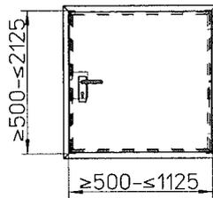
Konstruktion für nicht fußbodengleichen Einbau (d.h. bei sog. Verwendung in größerer Höhen) immer mit vierseitig umlaufender Zarge und vierseitig umlaufendem Dichtungssystem
