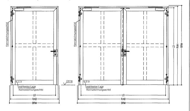
Dargestellt: Gangflügel DIN links Gangflügel DIN rechts spiegelbildlich. T30-1-RS-Tür und T30-2-RS-Tür immer mit unterer Bodendichtung ausführen und im Wandanschluss immer beidseitig versiegeln!
