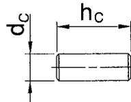
Verschlussstopfen (zum Verschließen des Dübeltellers)
