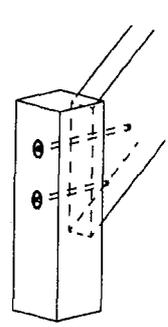
**Handlauffeckverbindung (mögliche Varianten)**
