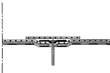
Abb.2 : Befestigung durch die Abdichtung mit Dachbahnteller / Zusatzstreifen
