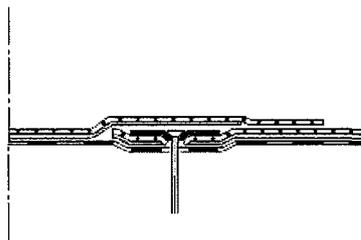
Abb.1: Befestigung im Überlappungsbereich ( Nahtsaum)
