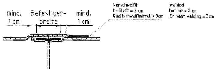
Abb.8 : Mindestüberdeckung im Längsnahtbereich
