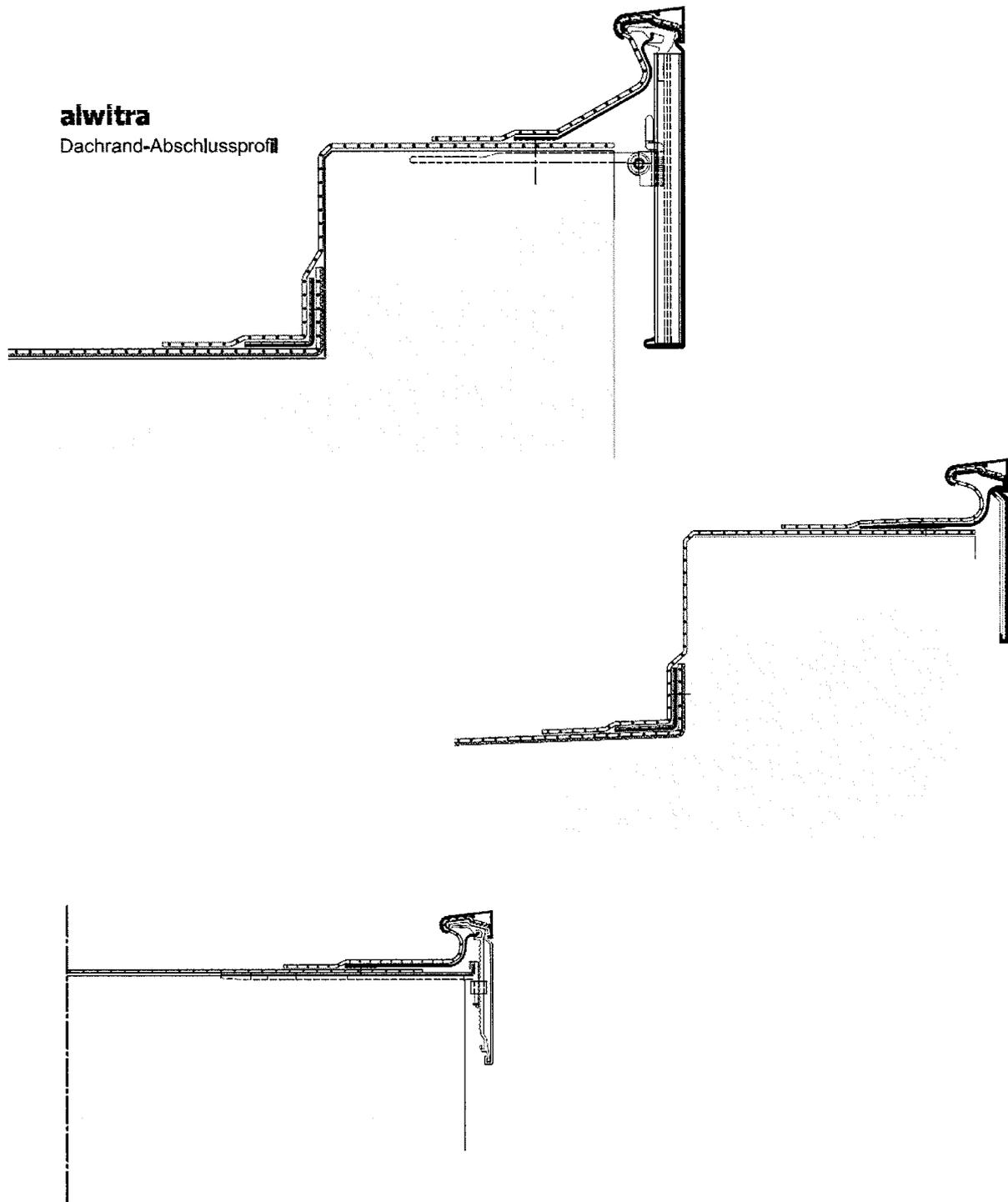
Abb.13.2 Dachrand- Abschlußprofil
