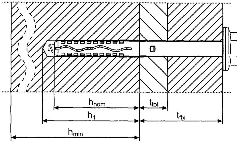
Anwendung in Loch- oder Hohlsteinmauerwerk
