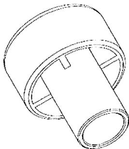
**Verfüllstutzen für Überkopf- oder Horizontalmontage**
