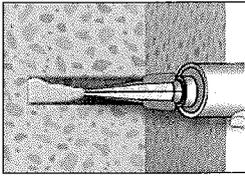
**6** Gereinigtes Bohrloch vom Bohrlochgrund her ca. zu 2/3 mit Verbundmörtel befüllen. Langsames Zurückziehen des Statikmischers aus dem Bohrloch verhindert die Bildung von Lufteinschlüssen. Für Setztiefen größer 190 mm passende Mischerverlängerung verwenden. Für die Horizontal- oder Überkopfmontage von Ankern > Ø 20 mm sind Verfüllstutzen gemäß Anhang 8 zu verwenden. Die temperaturrelevanten Verarbeitungszeiten (Tabelle 4) sind zu beachten.
