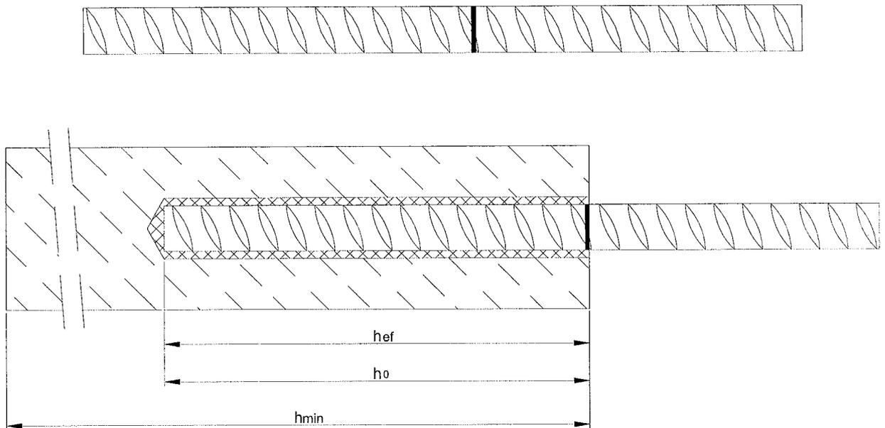
Henkel Injektionssystem CF 920 in Beton
