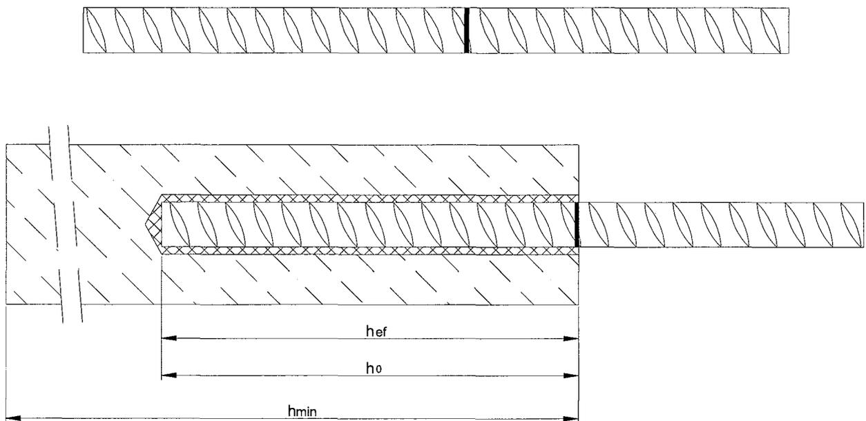
TRUHLAR Injektionssystem CM-V Vinylester in Beton
