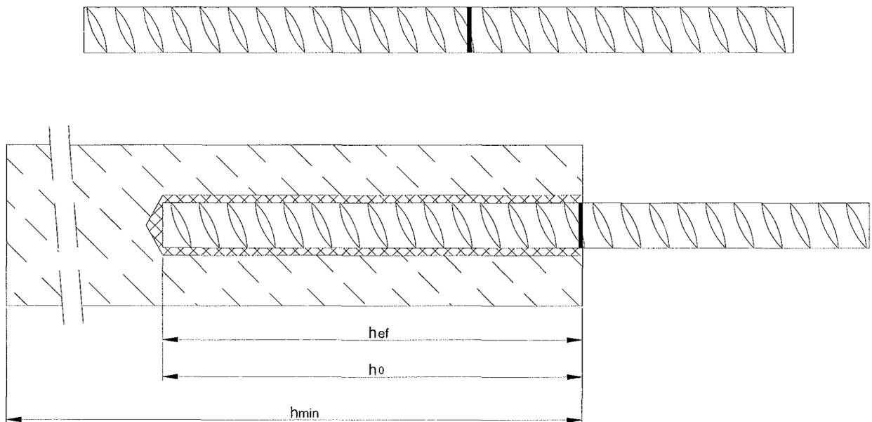
Chemofast Injektionssystem C-RE 385 in Beton
