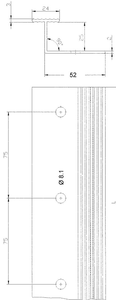
**Vertikales Verbindungsprofil "Sto-Verbindungsleiste PVC" (Maße in Millimetern)**
