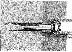
6. Gereinigtes Bohrloch vom Bohrlochgrund her ca. zu 2/3 mit Verbundmörtel befüllen. Langsames Zurückziehen des Statikmischers aus dem Bohrloch verhindert die Bildung von Lufteinschlüssen. Für Setztiefen größer 190 mm passende Mischerverlängerung verwenden. Für die Horizontal- oder Überkopfmontage von Ankern > Ø 20 mm sind Verfüllstützen gemäß Anhang 8 zu verwenden. Die temperaturrelevanten Verarbeitungszeiten (Tabelle 4) sind zu beachten.
