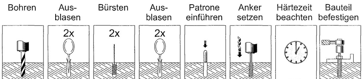
Installation in trockenem oder feuchtem Beton
