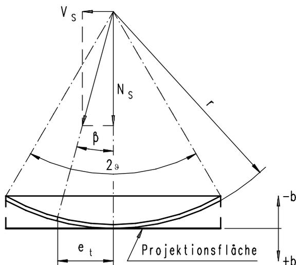
Abb. 1 - Nachweisschema für die gekrümmte Gleitfläche (Beispiel)
