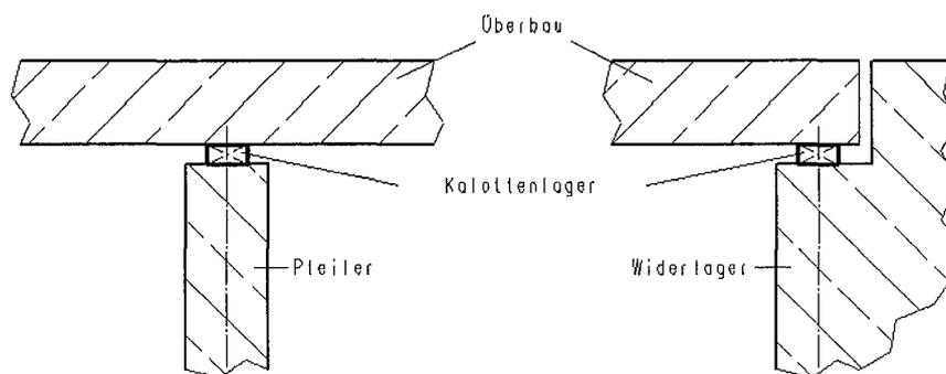
Abb. A.1 - Zusammenbau eines geführten und allseits beweglichen SMF Kalottenlagers und vorgesehener Verwendungszweck (Beispiel)
