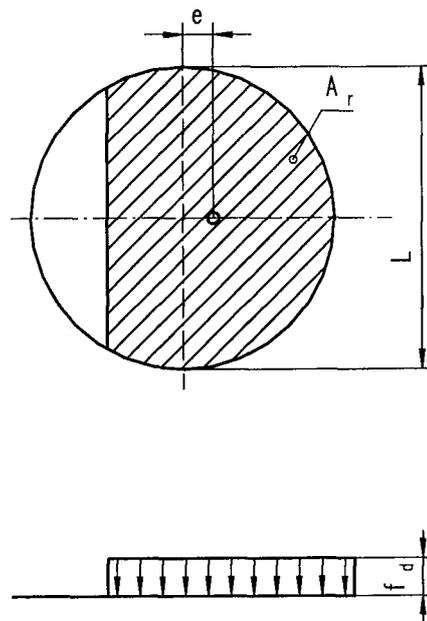
Abb. C.1 - Reduzierte Kontaktfläche  $A_r$  in kreisförmigen Gleitflächen
