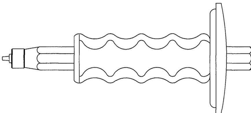
Schraubwerkzeug für Isoplus 8M und Isoplus 8S
