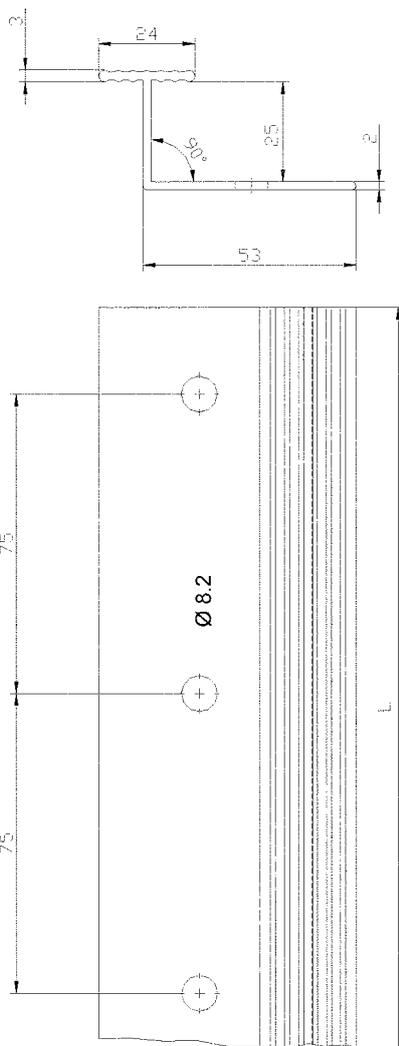
**Vertikales Verbindungsprofil "SCHWEPA Verbindungsleiste PVC" (Maße in mm)**
