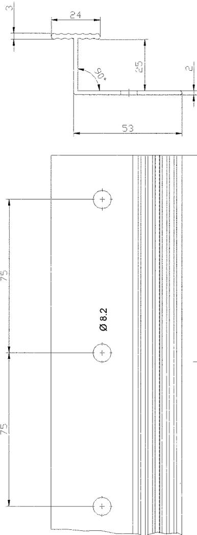
**Vertikales Verbindungsprofil "Terrasolar Verbindungsleiste PVC" (Maße in mm)**
