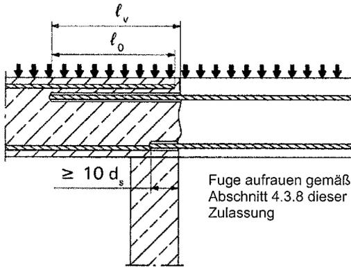
**Bild 2:** Übergreifungsstoß einer biegebeanspruchten Stütze oder Wand an ein Fundament
