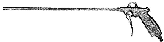
Empfohlene Druckluftpistole (min 6 bar) Bohrerdurchmesser (d 0 ): 10 mm bis 37 mm
