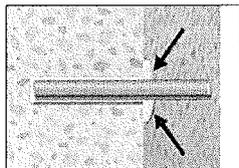
**8** Nach Installation des Ankers sollte der Ringspalt komplett mit Mörtel ausgefüllt sein. Tritt keine Masse nach Erreichen der Setztiefe heraus, ist diese Voraussetzung nicht erfüllt und die Anwendung muss vor Beendigung der Verarbeitungszeit wiederholt werden. Bei Überkopfmontage ist die Ankerstange zu fixieren (z.B. Holzkeile).
