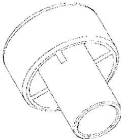
**Verfüllstutzen für Überkopf- oder Horizontalmontage**
