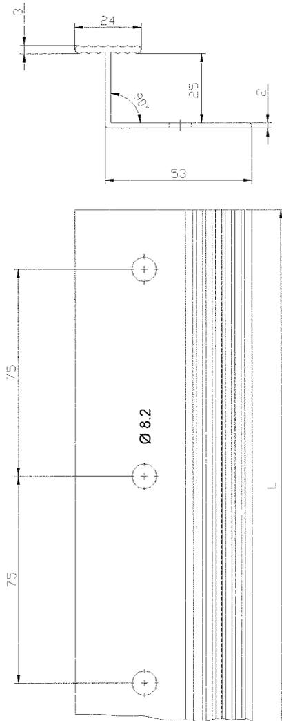
**Vertikales Verbindungsprofil– "SCHWENK Verbindungsleiste VL" (Maße in Millimetern)**
