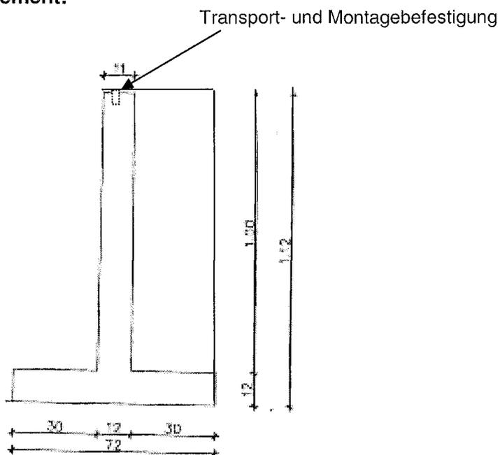
Fertigteilängen der T-Stütz- und Eck-Stützelemente: 1260 bis 2250 mm
