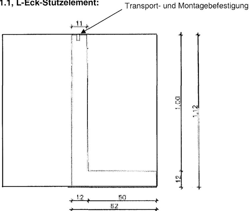
Fertigteillängen der L-Stütz- und Eck-Stützelemente: 1260 bis 2250 mm
