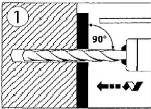
Bohrloch senkrecht zur Oberfläche des Verankerungsgrunds erstellen.
