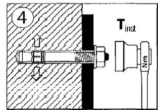
Montagemoment  $T_{inst}$  mit Drehmomentschlüssel aufbringen.
