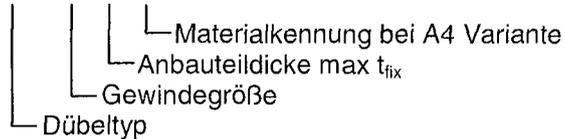
Buchstabencode der Kopfprägung und zugehörige maximal zulässige Anbauteildicke  $t_{fix}$ :
