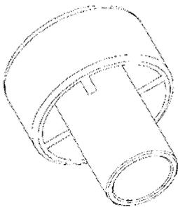
**Verfüllstutzen für Überkopf- oder Horizontalmontage**
