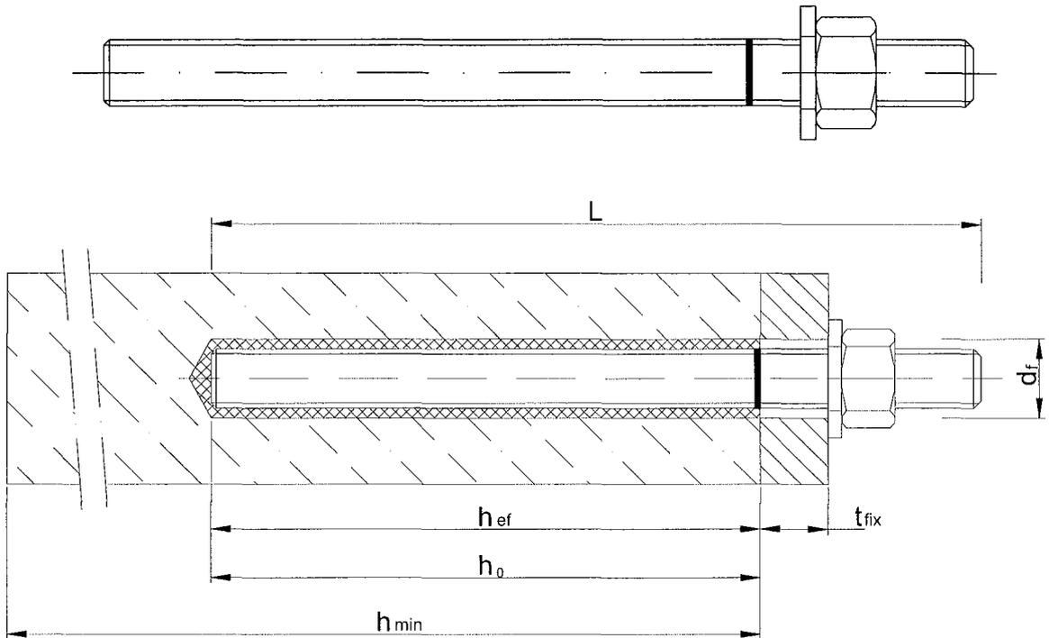
**Betonstahl  $\varnothing 8, \varnothing 10, \varnothing 12, \varnothing 14, \varnothing 16, \varnothing 20, \varnothing 25, \varnothing 28, \varnothing 32$  gemäß Anhang 4**
