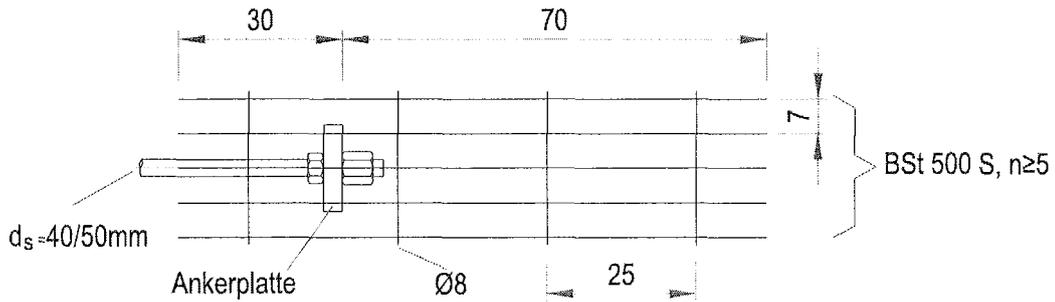
Bild 5 Beispiel für die Bewehrung einer Stütze
