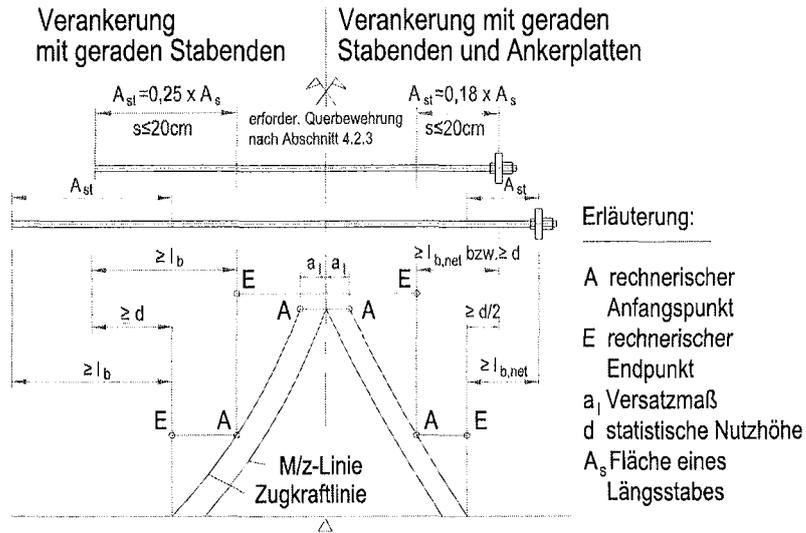
Bild 3b Beispiel für die Verankerung von Stäben  $d \approx 40$  bzw.  $50$  mm mit geraden Stäben und Ankerplatten im Stützbereich massiger Bauteile nach Abschnitt 4.2.2 (4)
