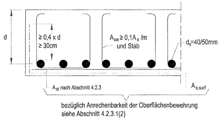
Bild 4b Balken und Anordnung von Steckbügeln bei mehrlagigen Bewehrungen
