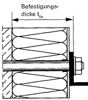
Befestigungsschraube/ Gewindestange/ Mutter und Scheibe muß immer dem Werkstoff der Innengewindehülse entsprechen. Siehe Anlage 5, Tabelle 4.
