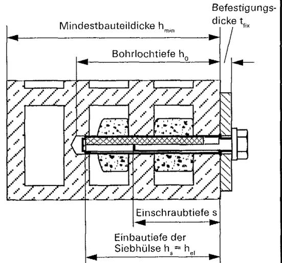
c) Einbau mit Ankerstange UVT Top A und Siebhülse UVT Top H 18x130/200 bzw. UVT Top H 22x130/200
