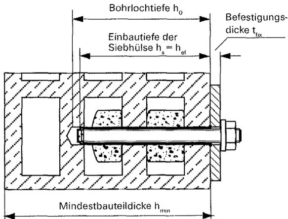
b) Einbau mit Innengewindehülse UVT Top E und Siebhülse UVT Top H (siehe Anlage 2)
