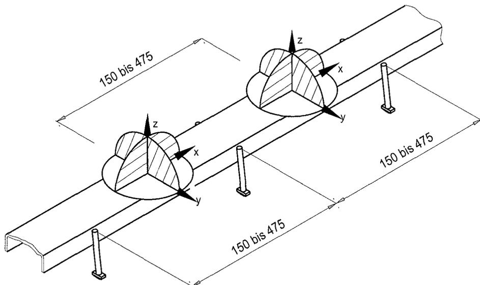
Bei gleichzeitiger Beanspruchung in alle Richtungen (Längszug-x, Querkzug-y, zentrischer Zug-z) darf die Lastresultierende die zulässigen Lasten nach Anlage 4 nicht überschreiten.
