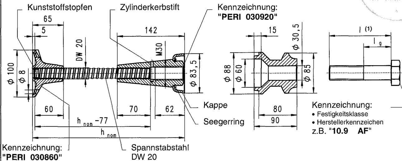
**Bild 5:** Einzelteile und Abmessungen PERI Kletterkonus 2 M 30/DW 20
