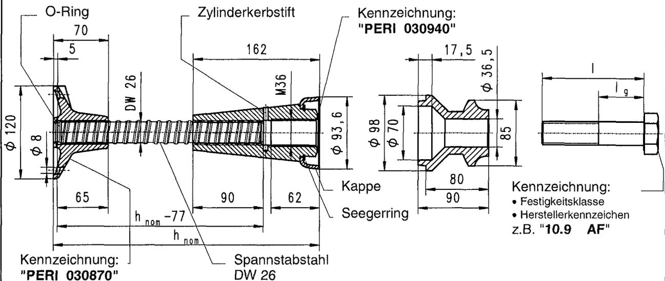
Bild 6: Einzelteile und Abmessungen PERI Kletterkonus 2 M 36/DW 26
