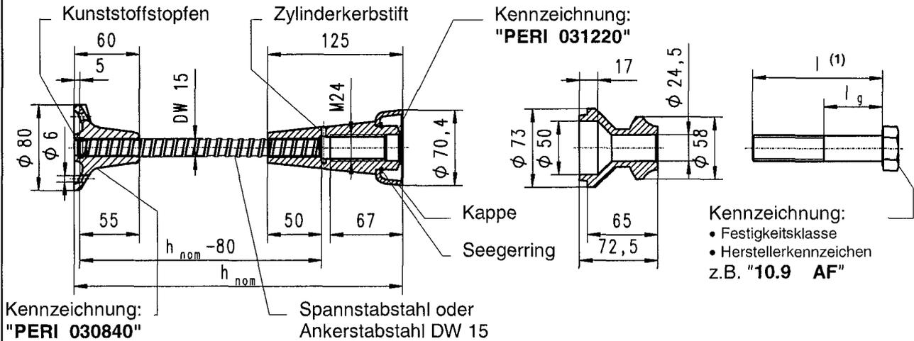
**Bild 4:** Einzelteile und Abmessungen PERI Kletterkonus 2 M 24/DW 15
