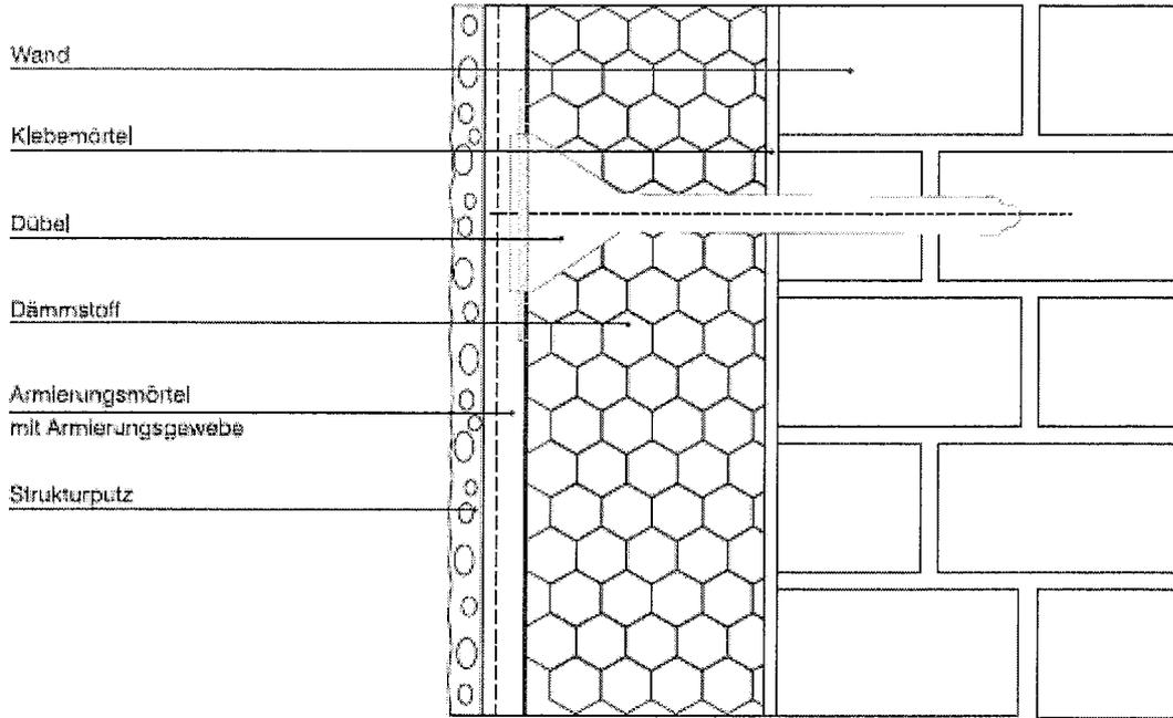
Teilflächige Verklebung der Mineralfaser-Lamellendämmplatten:
