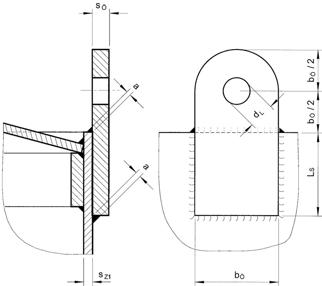
$$a \geq 0,7 \cdot s_{z1} \quad (\text{umlaufend})$$
