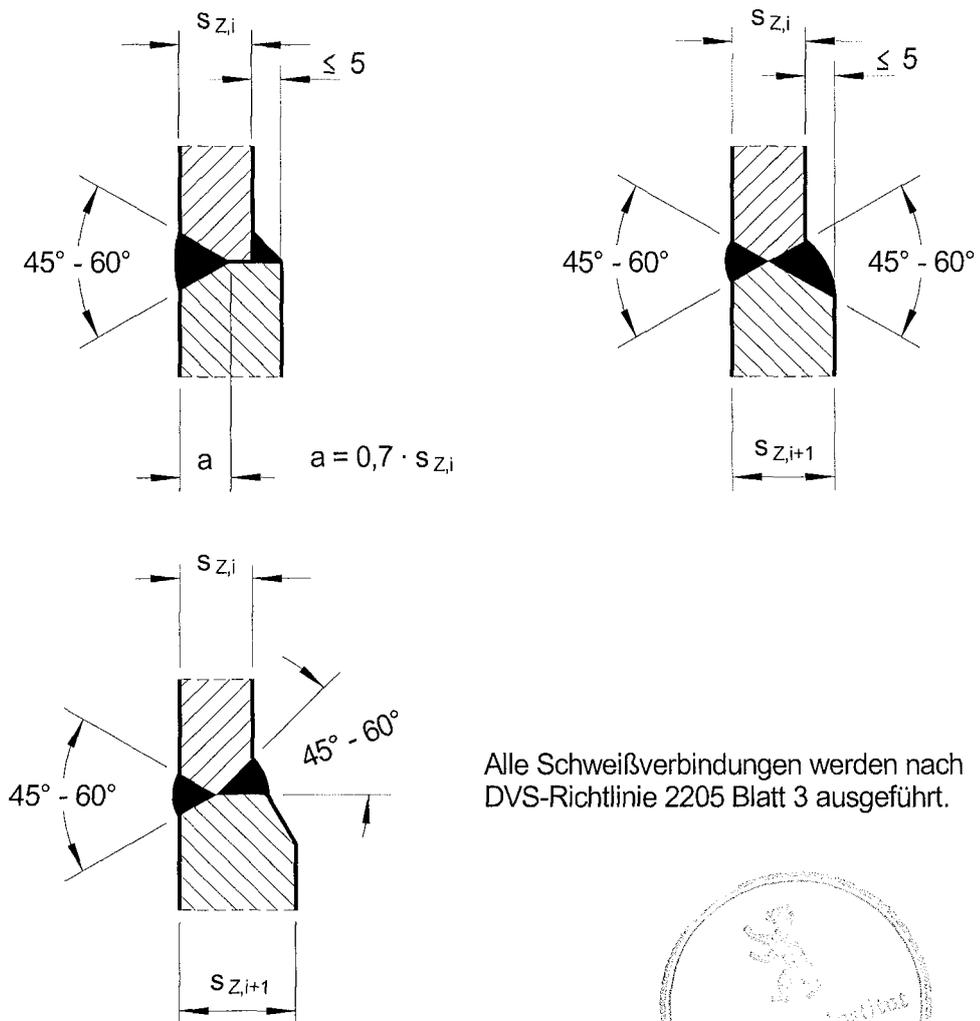
Alle Schweißverbindungen werden nach DVS-Richtlinie 2205 Blatt 3 ausgeführt.
