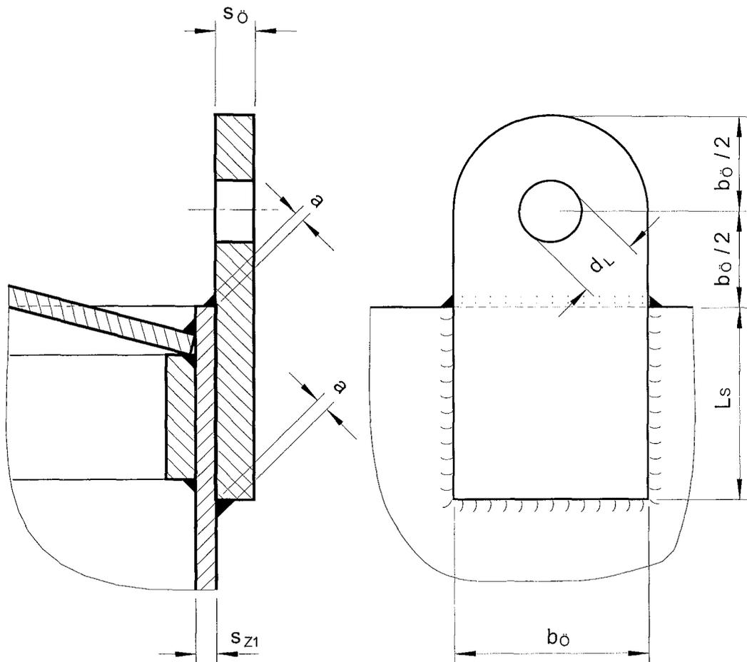
$$a \geq 0,7 \cdot s_{z1} \quad (\text{umlaufend})$$
