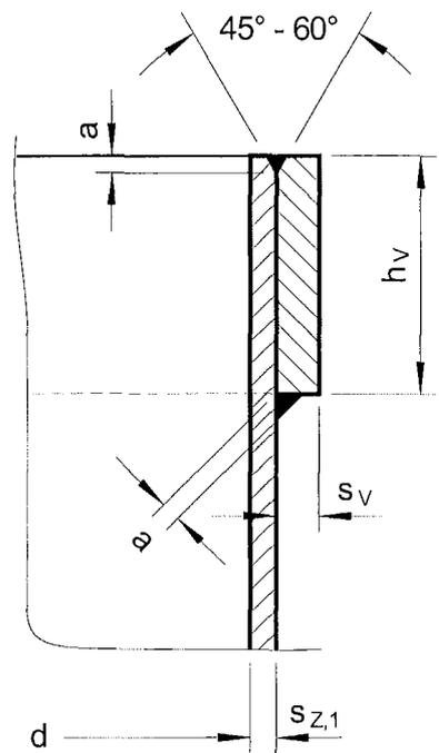
Die Randverstärkung darf auch an der Zylinderinnenfläche angebracht werden.
