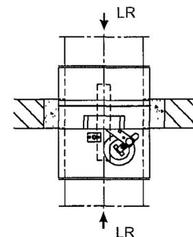
\*\* Bei Anschluß mit einseitigem Schutzgitter Widerstandsklasse K90. Das Klappenblatt muß immer im Gehäuse liegen (Gehäuse ab H = 449 mm verlängern, Klappenblatt muß im geöffneten Zustand beidseitig 50 mm im Klappenkörper liegen).
