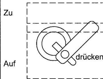
Schilder werden dauerhaft an der Handhebelseite jeder Absperrvorrichtung angebracht
