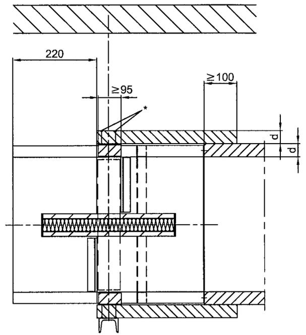
\* Die Befestigung der Unterfütterung mit der Plattenummantelung (der Plattenleitung) und der Absperrvorrichtung erfolgen in der leitungseigenen Fügetechnik
