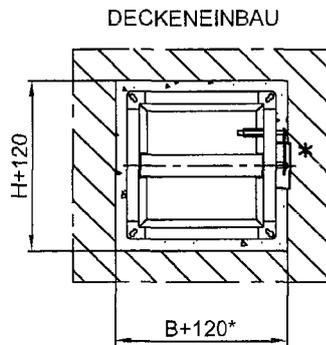
\* Entweder separate Aussparung für den Schutzkasten bei B + 120 oder den Durchbruch auf B + 160 vergrößern.
