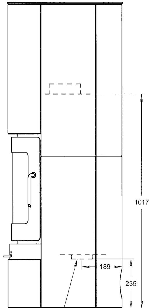
Lichter Durchmesser Luftanschlusstutzen: 94
