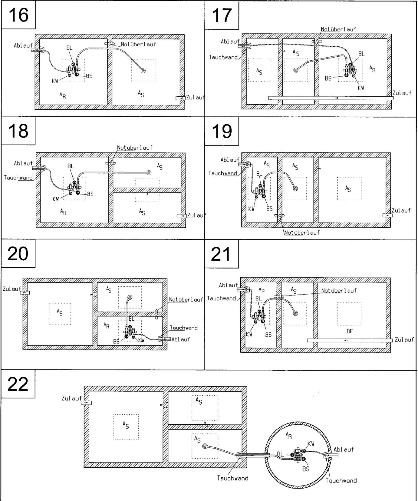
Abkürzungen: A<sub>S</sub> = Schlamm-speicher und Puffer, A<sub>R</sub> = Belebung, OF = Ohne Funktion, KW = Klarwasserpumpe, BS = Besickerpumpe, BL = Belüfter
