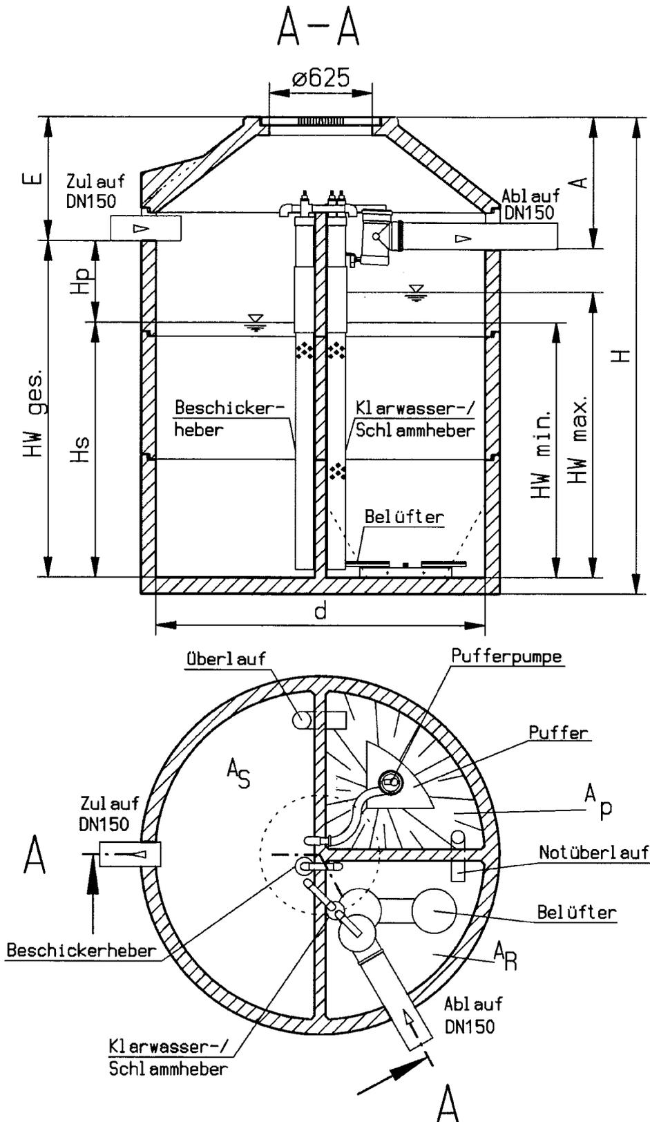
Alle Kammern können auch als separate, in unterschiedlicher Form und Größe, ausgebildete Behälter sein.
