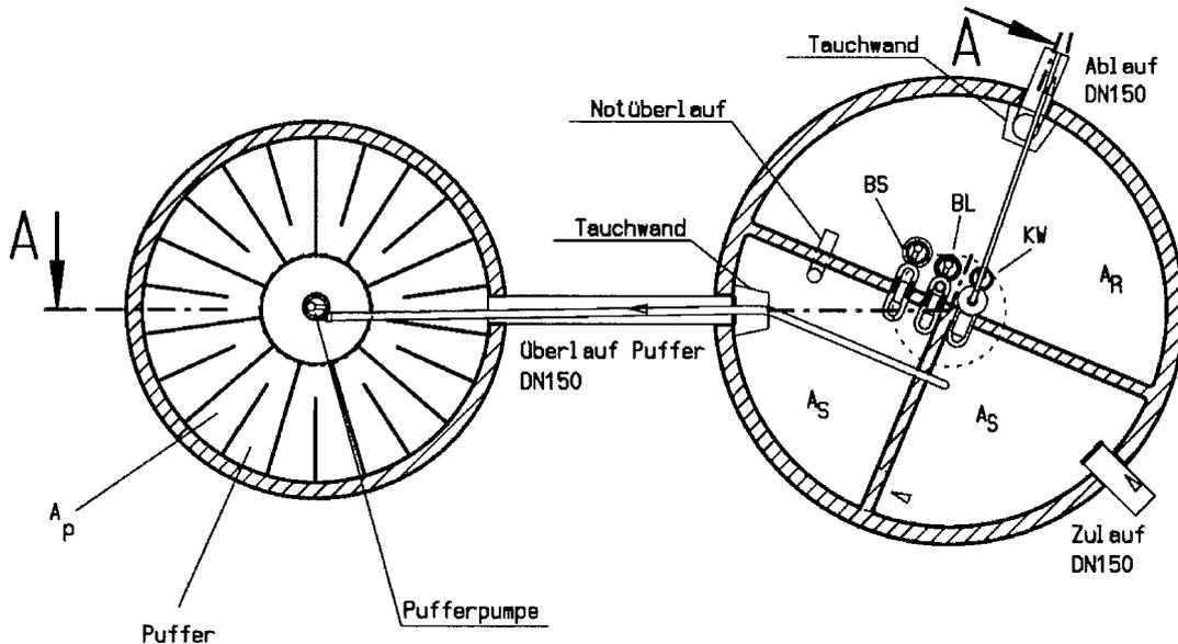
Alle Kammern können auch als separate, in unterschiedlicher Form und Größe, ausgebildete Behälter sein.
