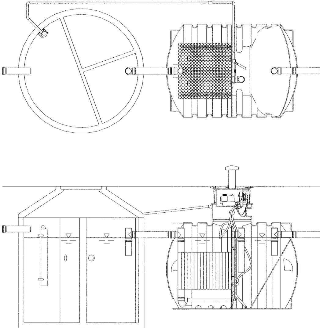
**Abbildung 2:** Beispielhafte Schnittdarstellung einer Dreikammer-Absetzgrube, nachgerüstet zu einer **DELPHIN** classic XS -Kleinkläranlage
