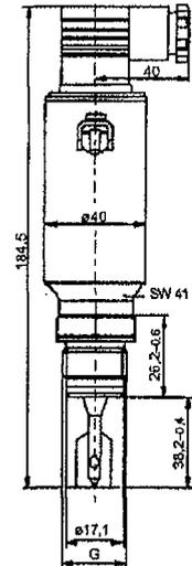
**Schema der Überfüllsicherung für Meßumformer FEL51, FEL52 und FEL54**
