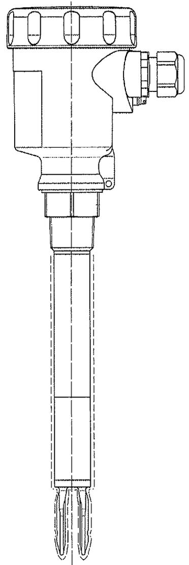
**Schema der Überfüllsicherung**
