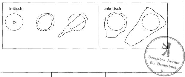
Semcoglas Holding GmbH Langebrügger Straße 10 D-26655 Westerstede Prüfung der Bruchstruktur von Testplatten in Bauteilgröße ANLAGE 2 zur allgemeinen bauaufsichtlichen Zulassung Nr. Z-70.4-101 vom 9. Juli 2009
