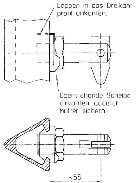
Der Gabelbolzen muß mit einem Anzugsmoment von 50Nm angeschlossen werden.
